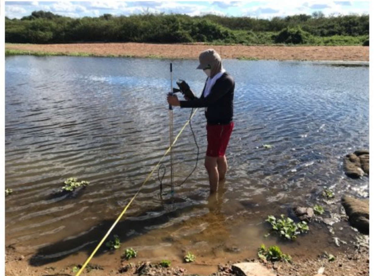
Foto: Medição de vazão seção Mapuá-Jaguaribe , Setembro de 2019.
